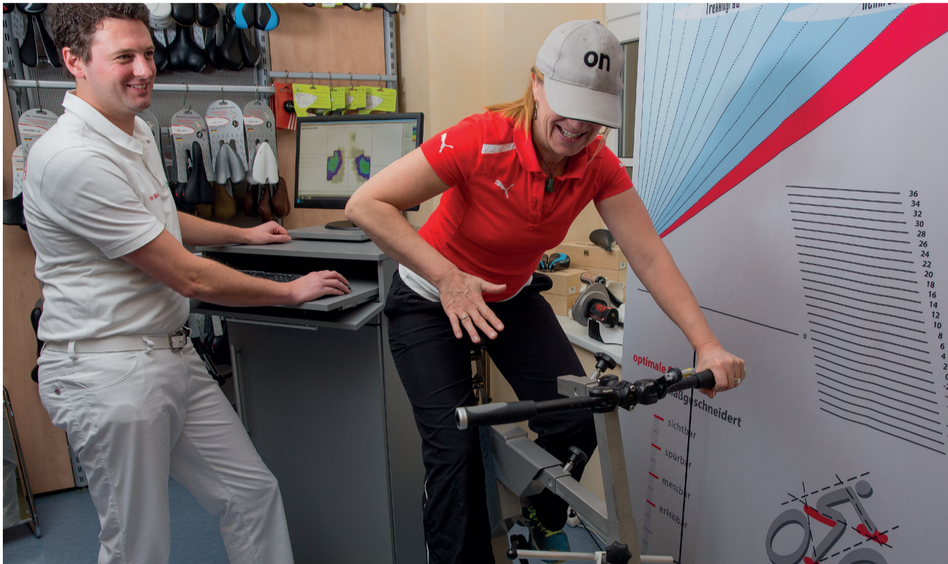
Per Physiotherameter analysiert Stephan Müller die genaue Druckbelastung des Sattels sowie die ergonomisch sinnvollste Sitzhaltung auf dem Rad.
